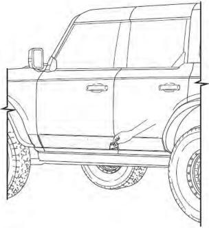
Seque toda la superficie con una toalla de microfibra. Inspeccione si hay suciedad o restos de la solución atrapados debajo de la película . Se utilizará el mismo proceso para todas las partes que se instalen.
