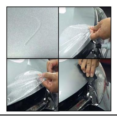
Envuelva una toalla de microfibra alrededor de su dedo y presione la orilla de la película. Esto sellará las orillas evitando la entrada de agua, polvo y evitará bolsas de aire debajo de la película. Se puede utilizar una pistola de calor en un ajuste de baja temperatura, a una distancia de 2 a 3 pulgadas de la superficie de la película protectora, para ayudar a secar y sellar las orillas evitando la entrada de agua o suciedad debajo de la película.
