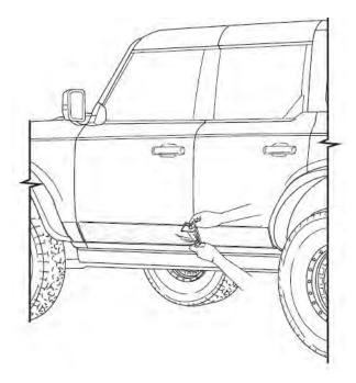
Para los dedos a lo largo de las orillas de la película, rocíe la solución tack en los dedos y utilizando el jalador envuelto en una toalla de microfibra presione o jale la solución hacia las orillas. La toalla de microfibra en conjunto con el jalador de agua ayuda con los dedos que se localizan a lo largo de las orillas para absorber la solución tack a medida que se va empujando la solución hacia la orilla de la película.
