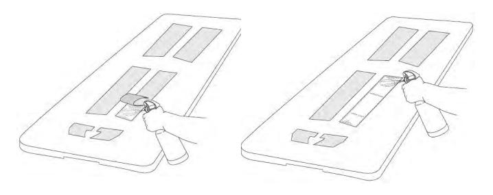
A continuación, rocíe la solución de montaje en el área o superficie del vehículo en la que se aplicará la película. Coloque la película en la superficie que desea proteger mientras identifica un punto de alineación como el centro, un emblema o una esquina en la superficie. Para la salpicadera lateral, el uso del faro y el panel superior del vehículo son generalmente los mejores puntos de alineación.
