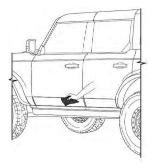
Si nota suciedad o algun tipo de contaminación por debajo de la película, rocíe sus dedos y cuidadosamente levante la película por la orilla mas cercana a la suciedad y rocíela con la solución de montaje. Utilice sus dedos para eliminar o remover la suciedad localizada debajo de la película. Una vez que la suciedad o la contaminación sea eliminada, rocíe de nuevo la película y la superficie del vehículo y presione con el jalador de agua de nuevo hasta dejarlo de nuevo en su lugar.
